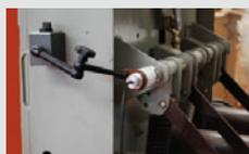
**PME-ATA:** Bras articulé adaptable avec base magnétique, transducteur rotatif numérique et adaptateur usinable pour axe de 19 mm.
