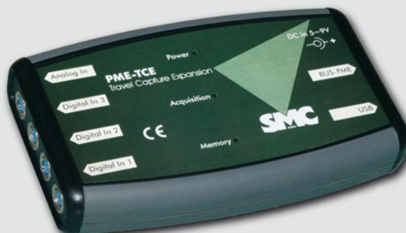
Le PME-TCE permet d'ajouter à l'analyse de l'interrupteur les données et les graphiques de vitesse, accélération et déplacement des pôles ou de n'importe quel élément mobile. Il prend son alimentation du PME-500-TR et permet de connecter jusqu'à trois transducteurs numériques et un analogique. Les résultats sont stockés de façon permanente dans sa mémoire et se téléchargent ensuite à l'ordinateur au moyen d'une connexion USB.
