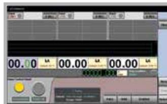
El modo de inyección polarizada (forma de onda asimétrica) permite la rápida localización de errores de polaridad en las conexiones con la ayuda de la sonda opcional Raptor Polarity Tester.
